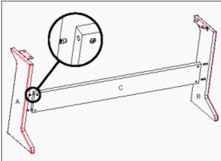
4. Соедините поперечную доску (С) правой (А) и левой (В) ножкой, закручивая четыре винта М6 (D2) в отверстия, совмещенные со стяжкой. Затяните винты, используя для этого прилагаемый гаечный ключ Allen (D4).
